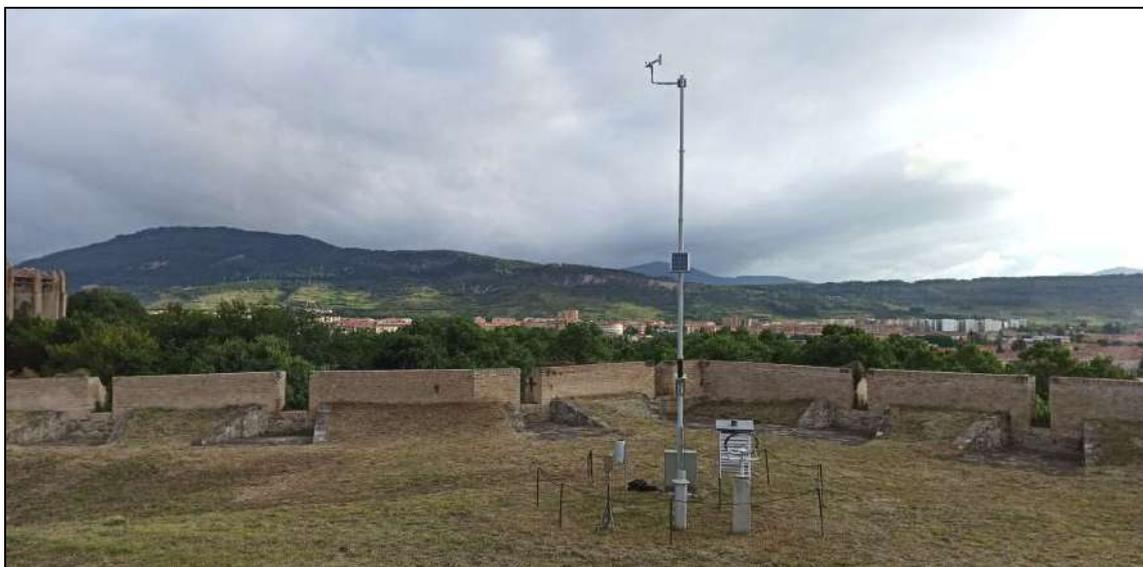
Figura 15. Imagen del pluviómetro de la red del Gobierno de Navarra situado en Pamplona, en la zona de la cuesta del Labrit, y muy próximo por tanto al término municipal de Burlada. Este pluviómetro ofrece y comunica datos de precipitación recogida de forma diezminutal.
